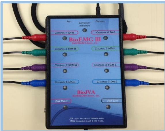
Figura 3. Una vez que todos los cables están conectados al amplificador, el programa BioPAK puede ser abierto. El amplificador del BioEMG III está ópticamente aislado de la interfase y de la computadora
