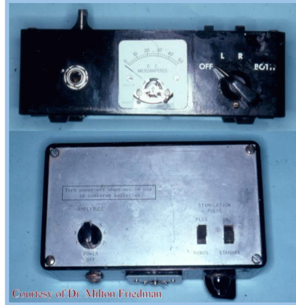
Figura 1. El primer prototipo del Myo-Monitor fue un aparato muy simple que emitía pulsos simultáneos de 2-milisegundos izquierdo y derecho cada 1.5 segundos.
