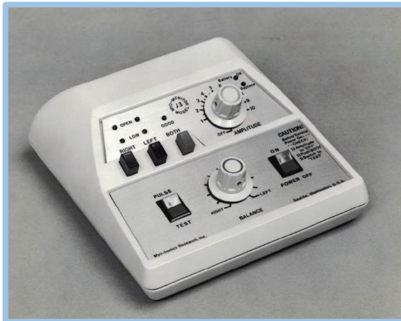
Figura 3. El segundo modelo de producción J3 de 1977. El switch para sobrecierre fue considerado innecesario, pero la configuración original de tres cables se mantuvo.
